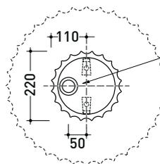
allaccio scarico tramite raccordo tecnico per lavabo in PP 40/50 mm con morsetto
